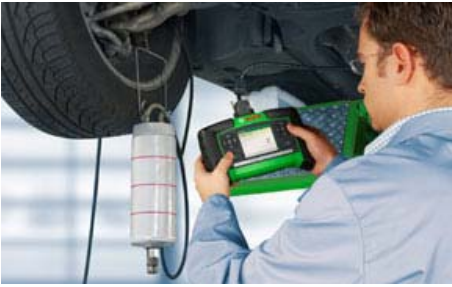
Mit einem Diagnosegerät lässt sich der jeweils korrekte Abrollumfang der Räder einstellen.
